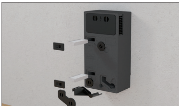
Fig. 52 Kontrollieren, dass beide Filter in Pfeilrichtung sowie die Abtropfschale an der Kondenswasserauffangschale (Fortluftöffnung) eingesetzt sind. Gerät ohne Filter, Revisionsdeckel oder Abtropfschale breiben. Es befinden sich am Filter sowie auf der Geräteeinsatzabdeckung Markierungen in Form eines Pfeils, deren Positionen übereinstimmen müssen.
